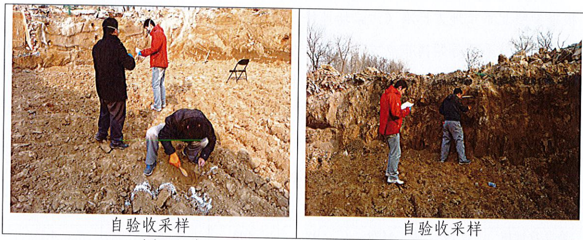
图 5-2 轻工业环境保护研究所基坑验收采样
